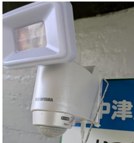
写真7 パターンAに取り付けたライト。 ソーラーパネルで給電する。
